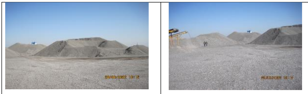
Рисунок 21 Заготовка гравийного материала для производства бетона и асфальта
